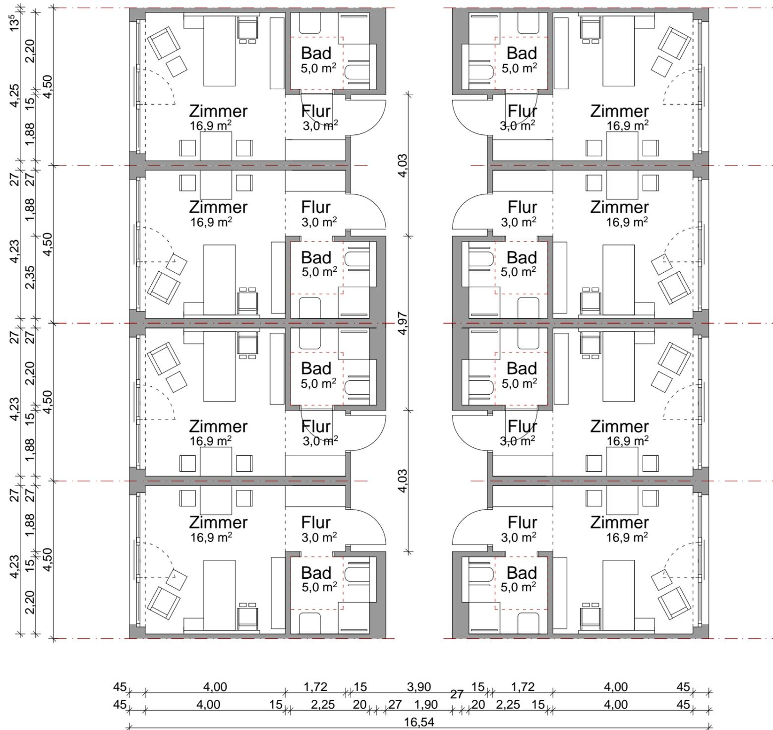
Schemagrundriss, M. 1:100, Achsmaß 4,50 m
