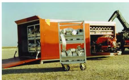
**BILD A2.18** AB-Schlauch in Ausführung der Fa. Brändle/CH mit in Rollwagen gelagerten Schläuchen [Thomas Zawadtke]
