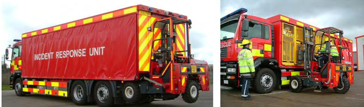
BILD A2.4 GW-N "XXL" einer brit. Feuerwehr mit Gitterpalettensystem und Mitnahmestapler [Werkfotos MOFFETT-KOOI]
