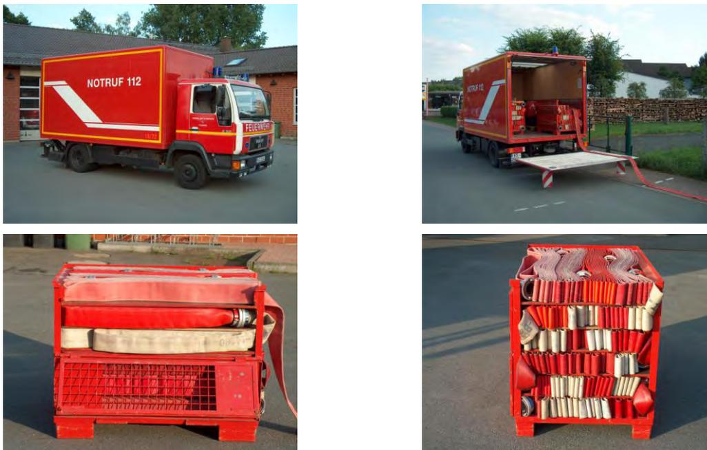
BILD A2.6 GW-N der FF Fuldata mit B-Schläuchen in Buchten in Gitterboxen [Stefan Finger, Fuldata]
