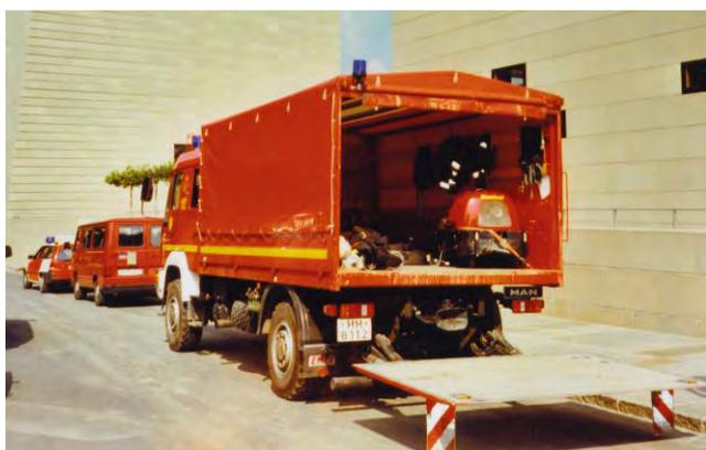
**BILD A2.8** Auch der Dekon-P hat sich als flexibler Mannschafts- und Geräteträger bewährt, hier beim Fluteinsatz in Dresden, August 2002. Fahren mit abgesenkter Ladebordwand ist aber schlecht möglich, wie dieses Bild zeigt. [de Vries]
