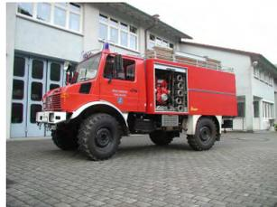
BILD A2.2 SW 1000 in Sonderausführung mit TS auf geländegängigem Fahrgestell [Christian Keller, Roland Bonath]
