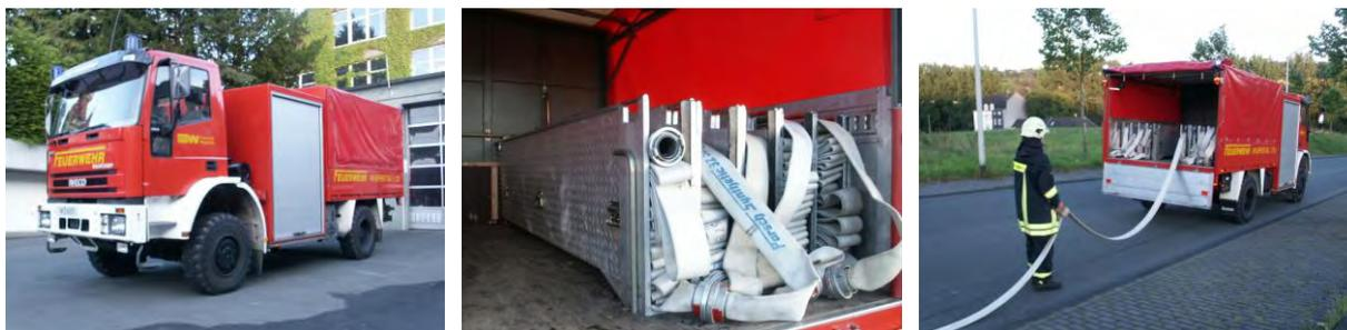
BILD A2.3 6-Personen-Schlauchtragekörbe auf der Ladefläche eines SW 2000-Tr (KatS)
