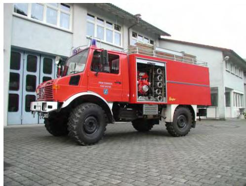
BILD A2.5 Abbildung 5: GW-N mit fest eingebauter Beleuchtung und B-Schläuchen in Rollcontainern [Ingo Horn]
