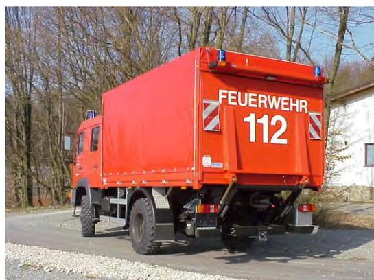
**BILD A2.9** Mehrzwecktransportfahrzeug mit Ladebordwand MZF nach Technischer Richtlinie Nr. 5 (Rheinland-Pfalz) [Werksbild HENSEL Fahrzeugbau GmbH & Co. KG; 97295 Waldbrunn]
