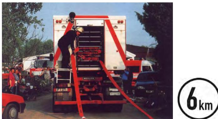
BILD A2.19 Einsatz eines Wechselladerfahrzeugs mit AB-Schlauch, beachte den Standplatz der Einsatzkraft (Quelle: [Matthias Schmidt, Feuerwehr Frankfurt a. M.] )
