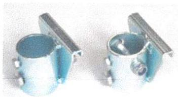
Handläufe werden mit „Hook“-Klammern an der Rampe befestigt. Die Klammern können an der Rampe bleiben, wenn diese zum Transport zusammengerollt wird. Eine „Plus“-Klammer (Bild rechts) empfiehlt sich, wenn die Rampe dauerhaft aufgestellt ist. Der Handlauf wird dabei durch eine Quer-Verschraubung zusätzlich gesichert.
