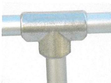
Die Rohre der Handläufe bestehen aus eloxiertem Aluminium, die Verbindungsteile aus Alu-Natur. Alle Stahlelemente (Hook-Klammern, Schrauben) sind galvanisiert. Dadurch wird eine besonders gute Eignung für den Außeneinsatz bei jedem Wetter erreicht.
